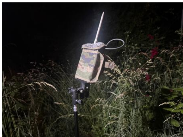
Abb. 37: Batcorder südöstlich des Gebäudes im Einsatz.
